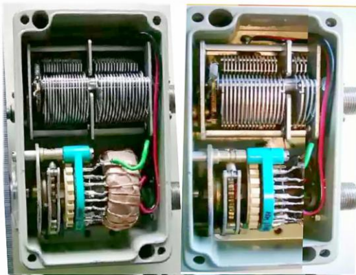
Mooi voorbeeld van het gebruik van een 4C65 ringkern in een antenne-tuner .Een keramische schakelaar met 11 kontakten kiest aftakkingen op de spoel .
