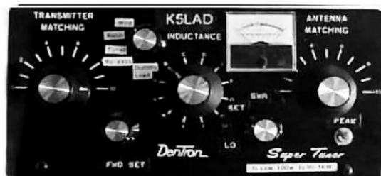
Voorbeeld van een mogelijke praktische uitvoering van een zelfgebouwde antenne-afstemmer , door K5LAD.(= niet dezelfde als besproken in de tekst: C's=verschillend).
