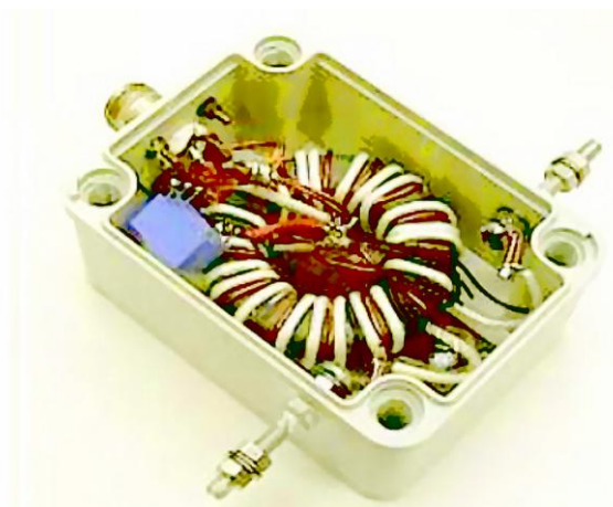
Foto van de 1:12 balun , toont enkele constructie-details .
