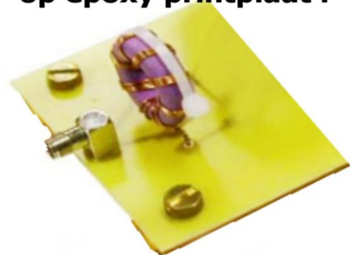
Fig. 33 Onder de moeren van deze schroeven worden de goed blankgemaakte draaduiteinden van de te voeden antenne goed elektrisch geleidend gesoldeerd. Onderaan de volledig uitgevoerde balun wordt een gaatje geboord om eventueel
