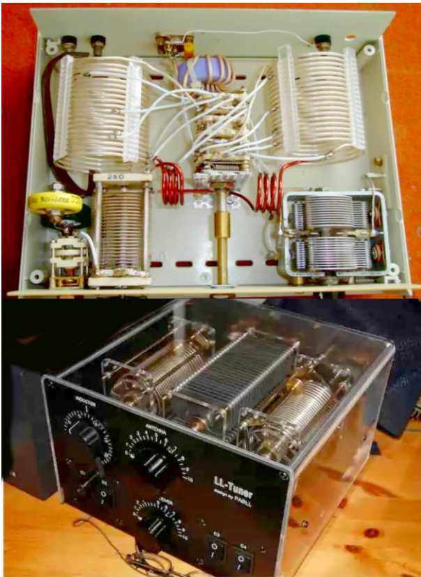
Mooie voorbeelden van de mogelijke uitvoering van een zelfgemaakte antenne-afstemmer. Gevonden op het internet bij PA0LL, PA3EKE en ZS6BKW.
